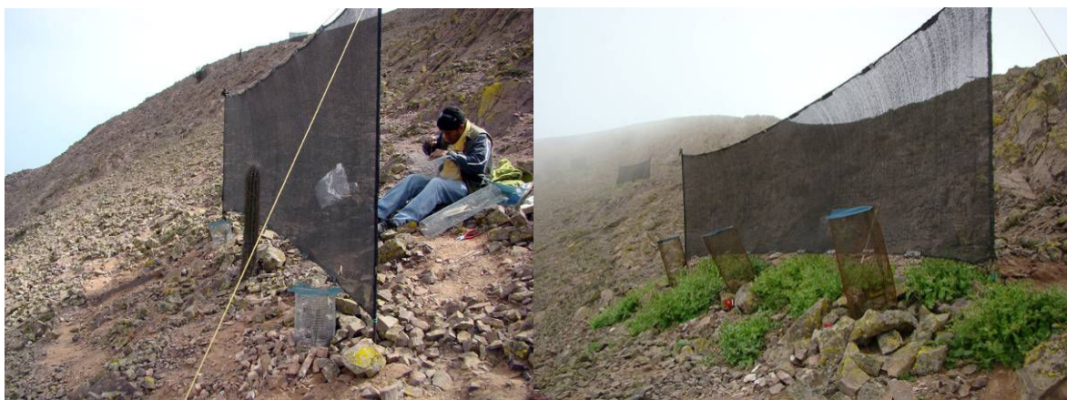
FOTO 29. En septiembre se produjo la aparición de vegetación herbácea bajo los atrapanieblas. En tres meses las rejillas quedaron totalmente oxidadas.
