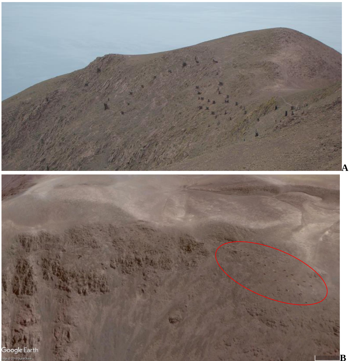
FOTO 1. Distribución de los atrapanieblas instalados en los altos del ecosistema de niebla de Punta Gruesa. A. Vista desde el lugar. B. También se logran visualizar como puntos negros el en Google Earth sobre todo en el sector oriente (círculo rojo) de sustrato poco rocoso.
