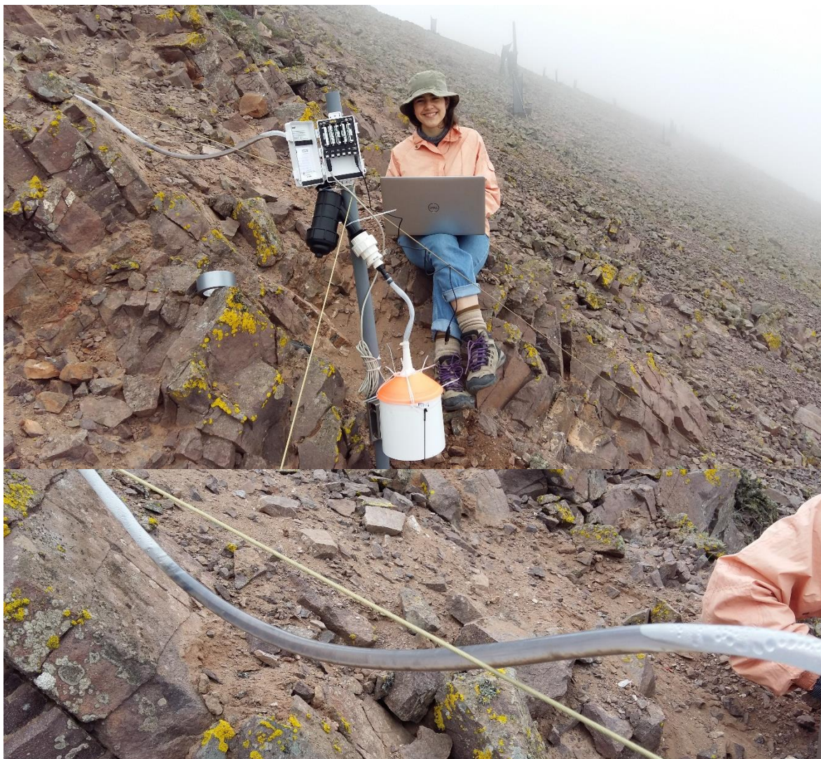
FOTO 2. En septiembre 2019 se bajaron los datos para verificar que todo esté funcionando bien. Es inevitable la arena que es acarreada por el viento que cae a la canaleta y el agua la lleva por la manguera que se acumula en la curva de ésta.
